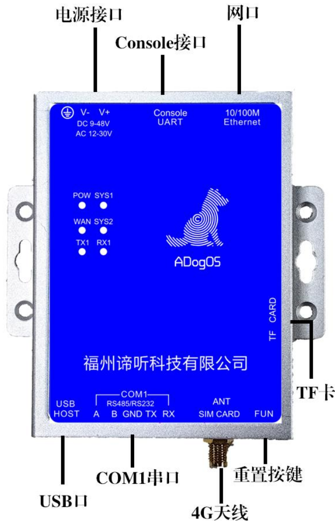
图 2-1 DT-BOX-26 接线图
