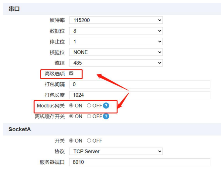
图 2-5 modbus 协议配置
