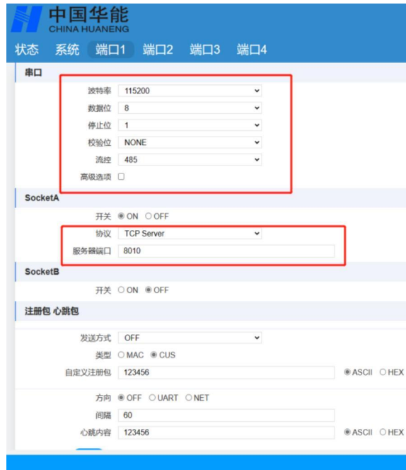
图 2-4 无 modbus 协议配置
